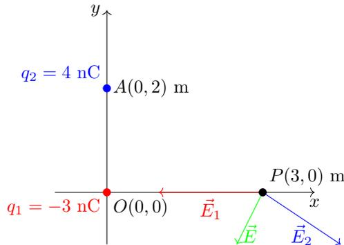
Utilizaremos el principio de superposición y la fórmula del campo eléctrico generado por una carga puntual:
